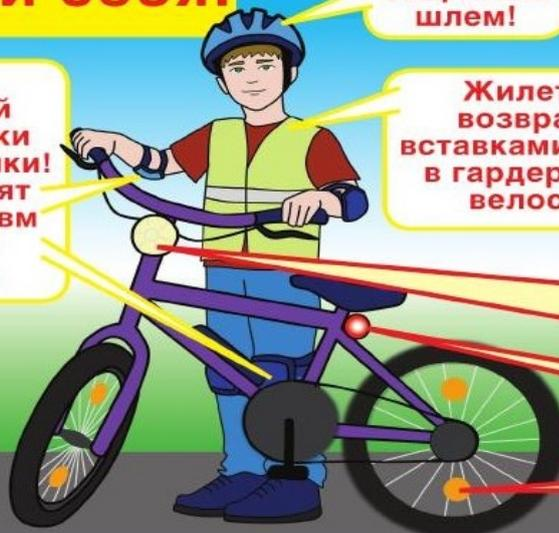
Велосипед должен иметь исправные тормоз, руль и звуковой сигнал, быть оборудован спереди световозвращателем и фонарём или фарой (для движения в тёмное время суток и в условиях недостаточной видимости) белого цвета, сзади — световозвращателем или фонарём красного цвета, а с каждой боковой стороны — световозвращателем оранжевого цвета.
